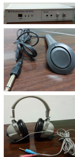
純音聽力檢測儀主要組成 部份 (主機、耳機、應答器)
